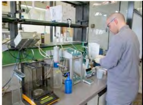
Waschflaschenapparatur mit Messgaspumpe
